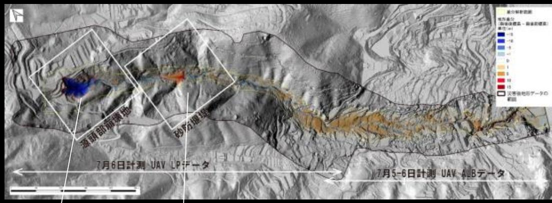
約55,500㎡が崩壊 → 約7,500㎡を砂防ダムが捕捉 → 残りの大部分が下流へ
