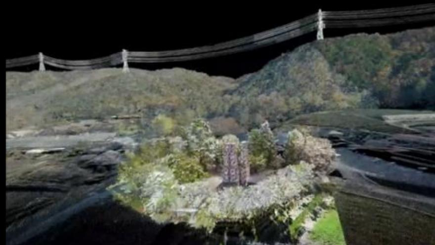
点群データ：レーザスキャナ等で計測したX,Y,Zの位置情報を持つ膨大な点の集まり
