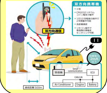
20mW型:リモコン用途の例
