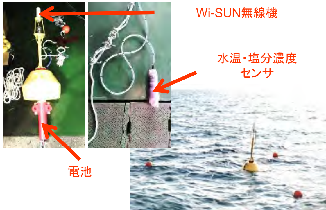
Wi-SUN無線機搭載センサブイと設置の様子
