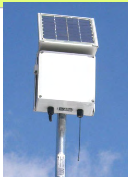
開発したAd-Hocネットワーク中継機
