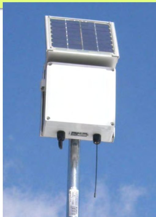
開発したAd-Hocネットワーク中継機
