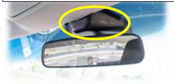
フロントガラスに設置したオンガラスアンテナ
