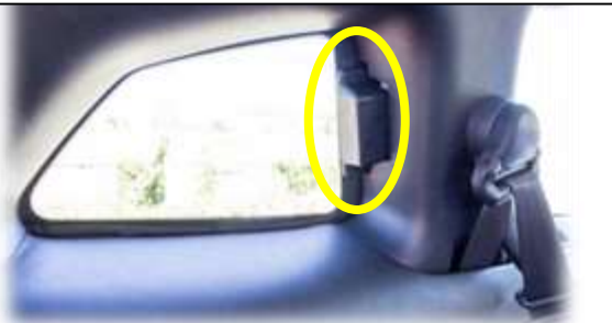
リアクォーターガラスに設置したオンガラスアンテナ
